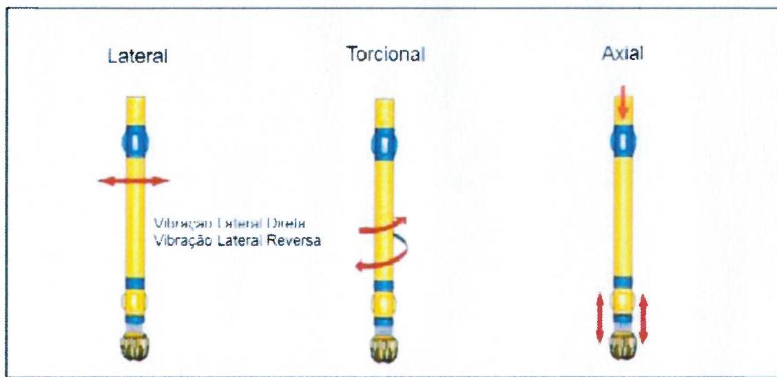
Figura 2.1. Modos de vibração em colunas de perfuração (ROCHA, AZUAGA, et al., 2008)
