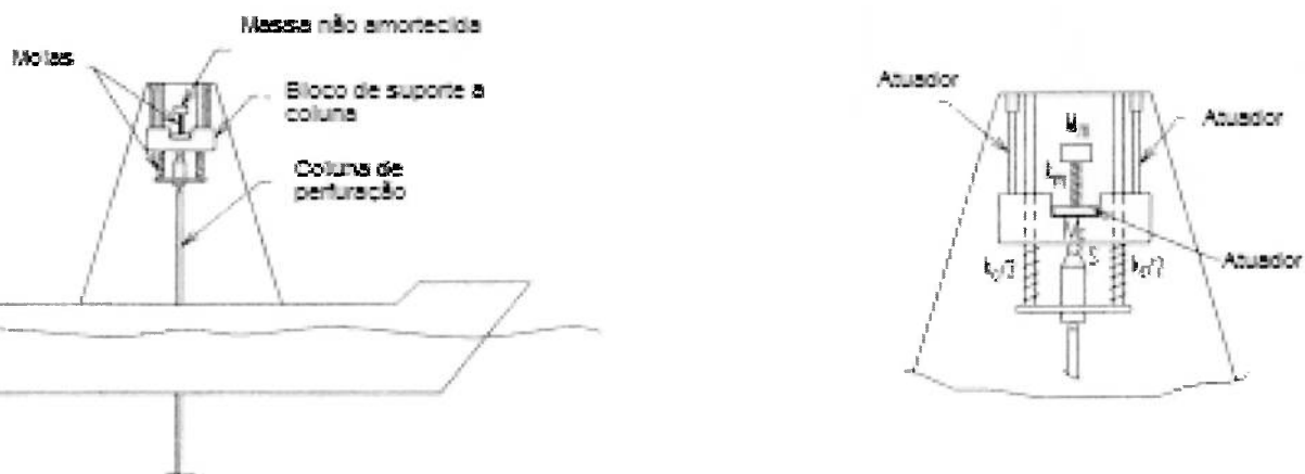
Figura 4.1 Esquemática de um sistema ativo de compensação de heave (UMESH, 1998)
